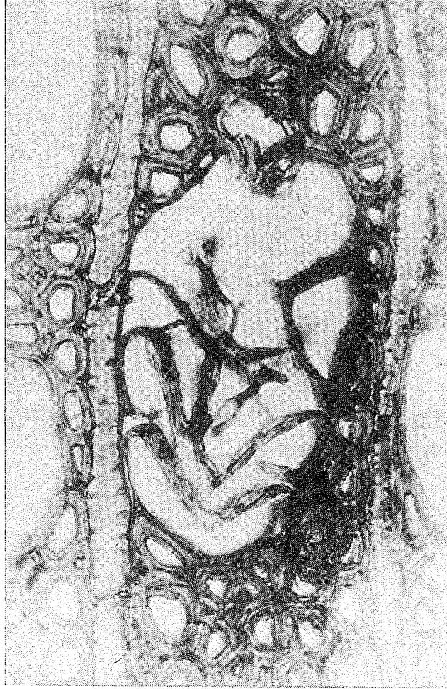
Resim 3 — P. euphratica oliv. odununda thyll teşekkülâtı Picture 3 — The formation of thyll in P. euphratica oliv. wood.
