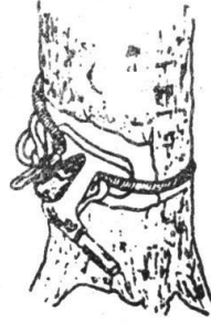
ŞEKİL-7 Gövde presı ( ağaca dipten sarılarak sıkılmış durumda ).
